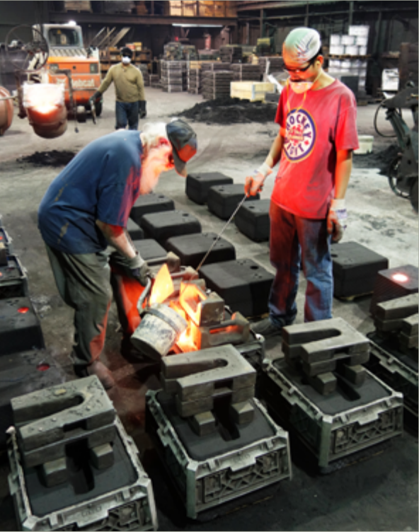
Moulage en sable des charnières fixées aux fenêtres d’origine de l’édifice Birkbeck (Toronto), siège de la Fiducie du patrimoine ontarien. (Lake Foundry, Grimsby)
