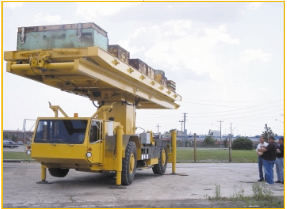
Arva Industries a construit cet installateur de pans de toiture pour soulever et tenir en position de lourdes dalles de plafond pour le projet « Big Dig » de Boston évalué à 10,8 milliards de dollars. La machine a été mise à l'essai à St. Thomas avec une charge de 30 300 kilos.
