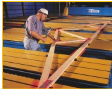
Le système TrussLine®, qui sert à la préfabrication des fermes, utilise la technologie à gabarit de Virtek.
