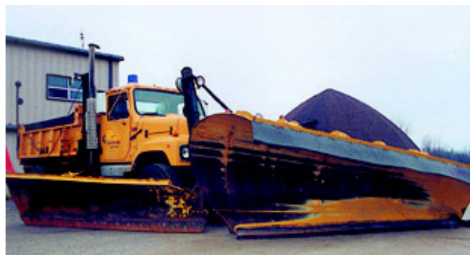
Un camion chasse-neige pourvu de la nouvelle lame en caoutchouc.
