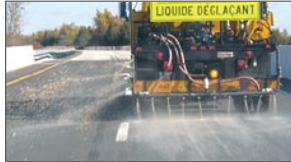
Application liquide directe sur deux voies par camion-citerne
