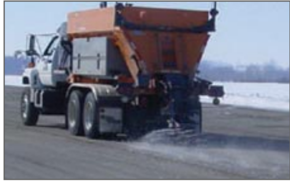
Épandeur arrière de sel à la volée sur une voie
