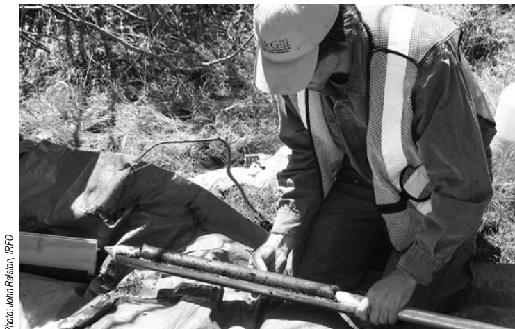
Benoît Hamel, coordonnateur de la recherche dans le Grand Nord, extrait un échantillon de tourbe au moyen d'un carottier à tourbe russe.
