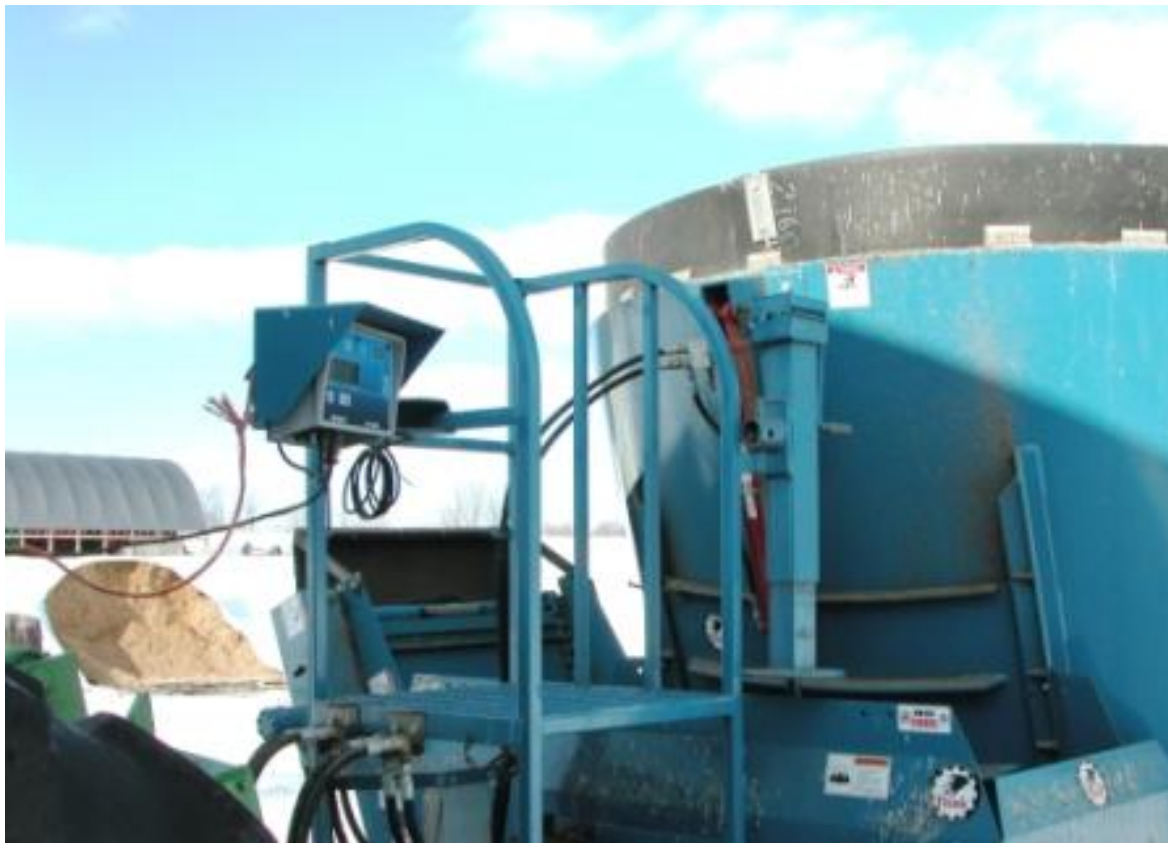
Figure 2. Pour réduire les rations de foin, les mélangeurs TMR sont de bons appareils qui vous permettront de mélanger le maïs à ensilage et les aliments comestibles avec le fourrage grossier
