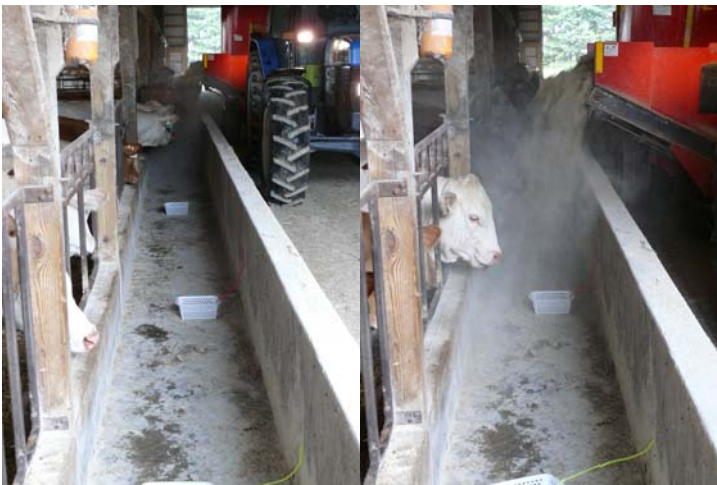
Figure 1. Un plateau placé au fond d'une mangeoire dans le cadre d'une analyse séquentielle du sodium visant à déterminer le c.v. d'un mélangeur.
