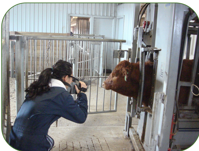
Figure 1 Évaluation du rayonnement infrarouge (imagerie de la tête) émis par une génisse retenue dans un couloir de contention.
