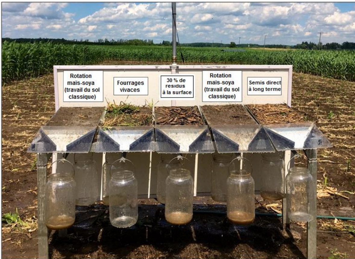
Figure 2 : Ce simulateur de précipitations montre comment les décisions de gestion du sol influent sur l'infiltration de l'eau (bocaux en arrière-plan), l'écoulement de surface (bocaux au premier plan) et l'érosion des sols qui en résulte.
