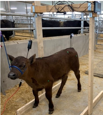
Veau debout sous le prototype de système de caméra utilisé pour saisir des données visuelles servant à estimer le poids vif
