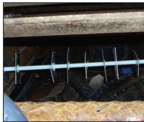
Des plaques de métal fixées sur un véhicule d'entretien hivernal permettent d'évaluer l'efficacité des inhibiteurs de corrosion.
