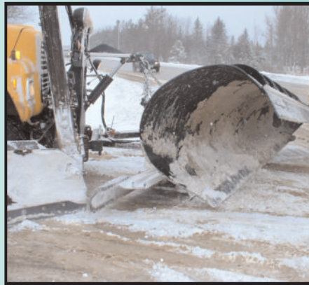
La lame à deux phases est assortie d'une plus petite lame traînante dotée de segments flexibles qui déblaient la neige poudreuse et la neige fondante.
