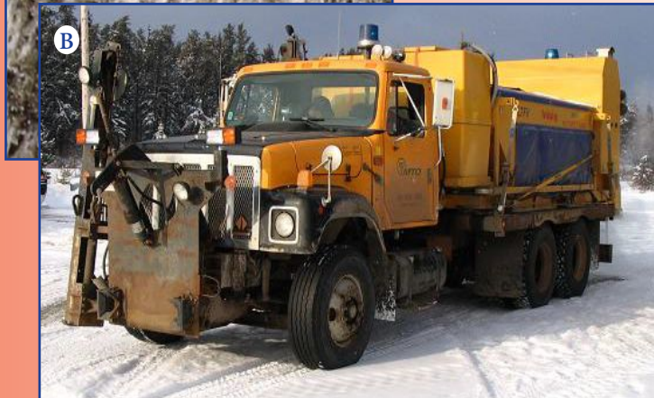
B: L'épandeuse de sable à l'eau chaude est un modèle modifié de saleuse traditionnelle.
