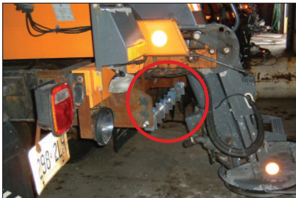
Illustration 2 : Coupons d'essai installés sur des véhicules servant à l'entretien des routes en hiver.
