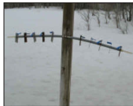
Illustration 1 : Coupons alternés en acier et en aluminium suspendus à des tiges de nylon filetées pour des essais sur le terrain effectués à Ottawa.
