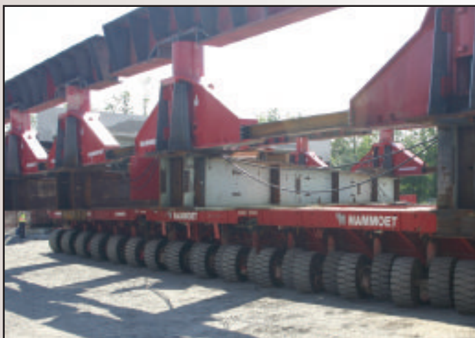
Illustration 1 : Démonstration du fonctionnement des transporteurs de modules autopropulsés (TMA).
