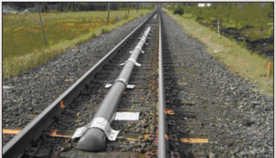
Illustration 1 : Capteur de tassement des voies.
