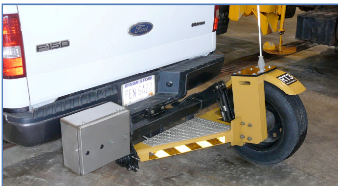
Un autre outil de mesure du frottement, le « Halliday RT3 », sert à modéliser la relation entre l'état des routes et les conditions d'adhérence lors des tempêtes d'hiver.
