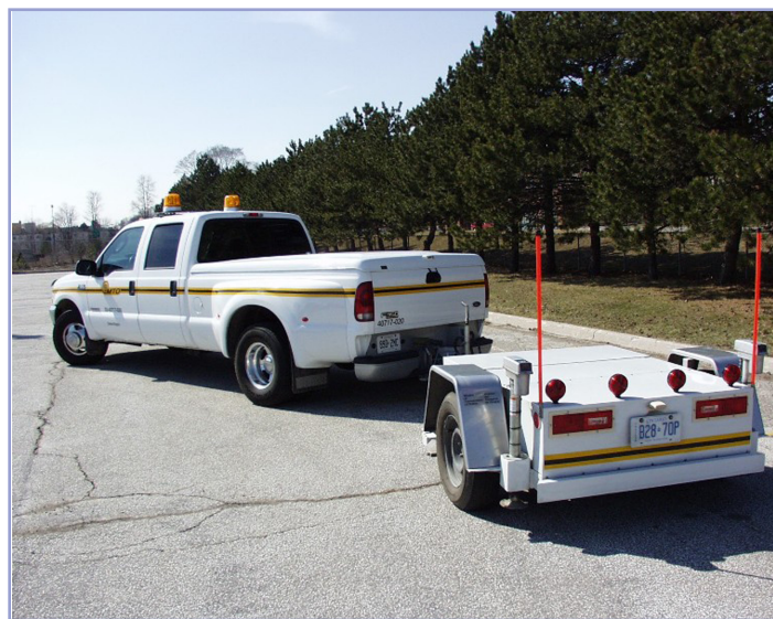
Une remorque de freinage ASTM E-274 attachée à un camion standard de la flotte du MTO
