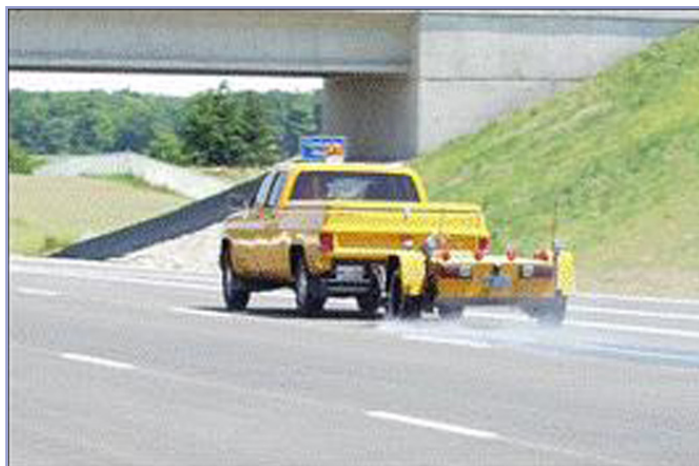
Démonstration d'une friction contrôlée sur une surface de route mouillée simulée
