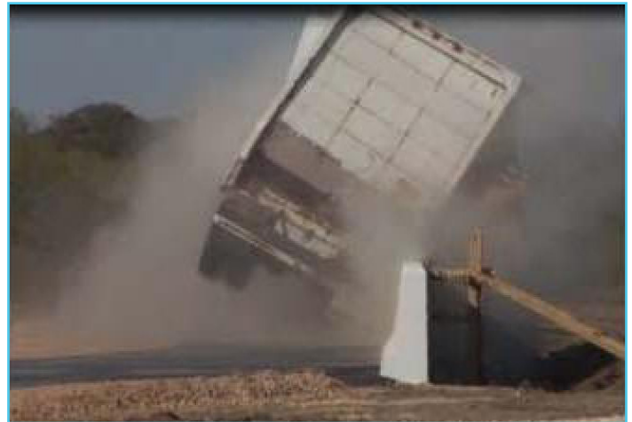
Essai de choc contre une glissière PL-3 avec un semi-remorque
