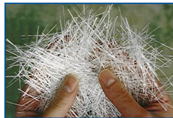
Brins de fibre de verre de 5 à 10 cm de longueur, utilisés pour l'application de la membrane SAMI.
