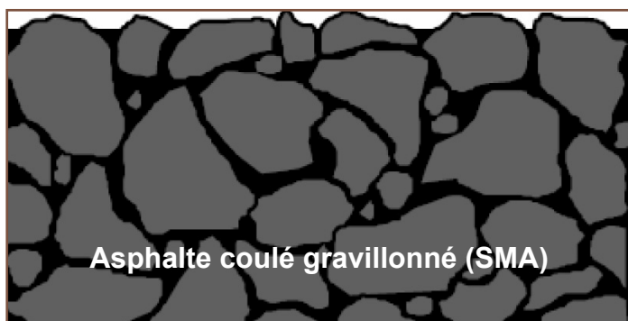
Figure 2 : Comparaison des structures du SMA et de l'AMC à densité classique
