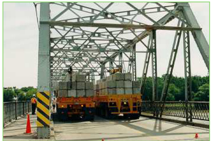
Figure 2 : Camions utilisés pour tester le pont
