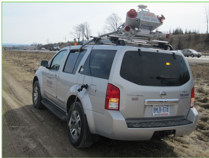
Figure 1b : Système de LIDAR mobile monté sur un VUS
