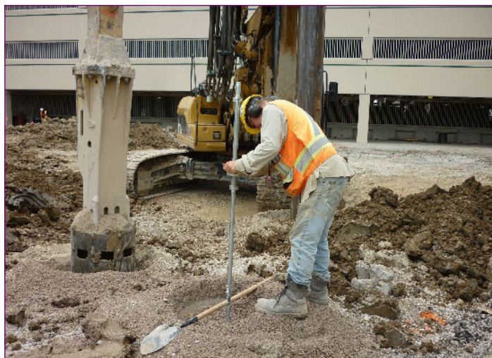
Figure 5 : L'essai dynamique du pénétromètre à cône à l'aide d'équipement manuel.
