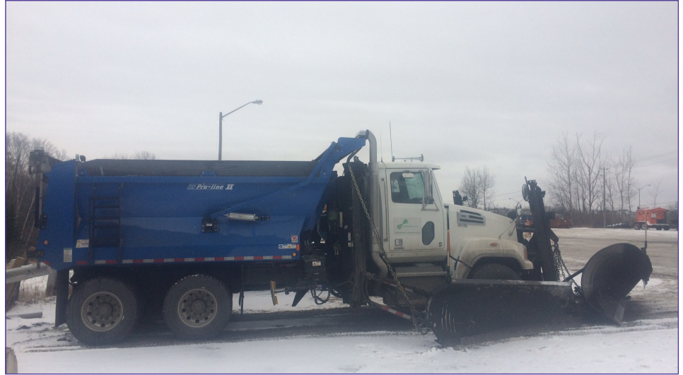
Figure 1 : Matériel d'entretien utilisé pour l'application du sel prétraité. À Verner, les véhicules utilisés pour l'entretien hivernal sont des camions polyvalents qui peuvent à la fois déneiger la route et épandre du sel.
