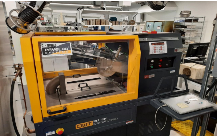
Équipement d'analyse des ornières bitumineuses dans le laboratoire dernier cri du MTO.
