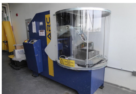
On utilise le compacteur de dalles bitumineuses pour créer des échantillons représentatifs de dalles aux dimensions variées qui sont constituées de mélanges hydrocarbonés déposées et compactées sur place.
