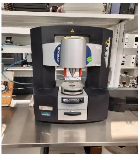
On utilise le rhéomètre à cisaillement dynamique (DSR) pour déterminer la viscosité et l'élasticité des liants d'asphalte à des températures moyennes et élevées. On utilise cet instrument pour étudier les propriétés des liants d'asphalte, à savoir les adhésifs imperméables qui tiennent ensemble les graviers d'asphalte.
