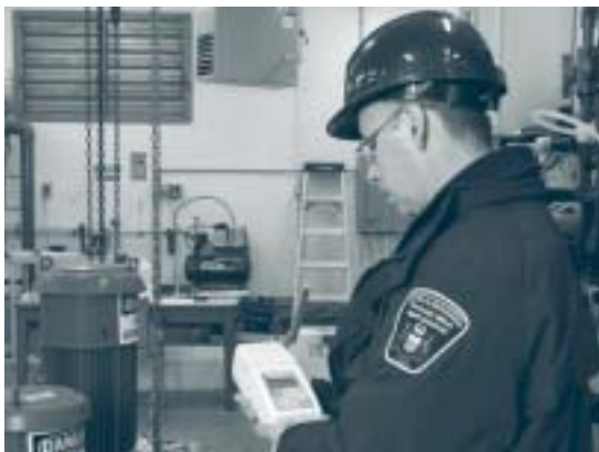
Un inspecteur du MEO mesure le chlore résiduel à l'aide d'un analyseur portable lors d'un contrôle sur place
