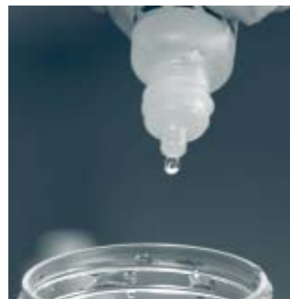
Un produit de conservation est ajouté à un échantillon d'eau potable
