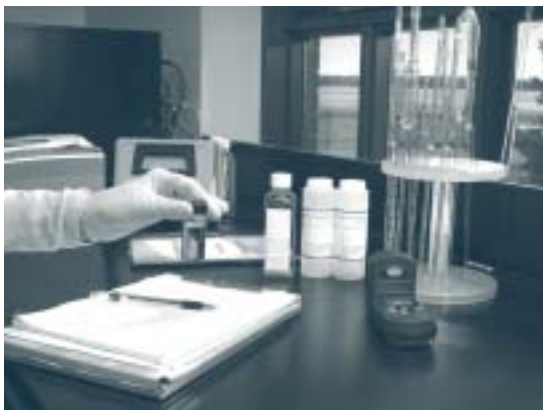
Mesure du taux de chlore résiduel à l'aide d'un analyseur portable
