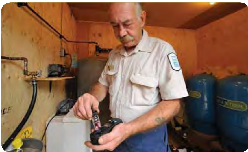
Un exploitant de petit réseau analyse un échantillon d'eau potable pour mesurer les concentrations de chlore.
