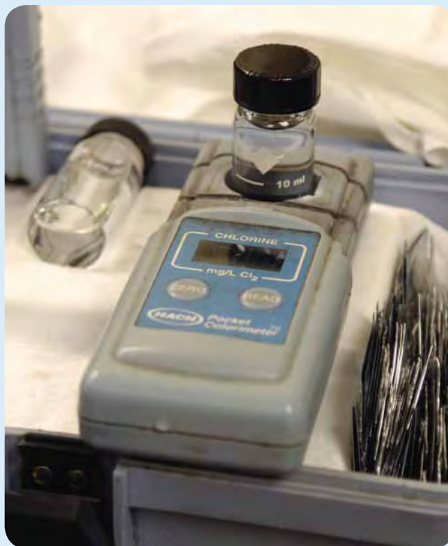
Un analyseur de chlore utilisé pour analyser les concentrations de chlore.
