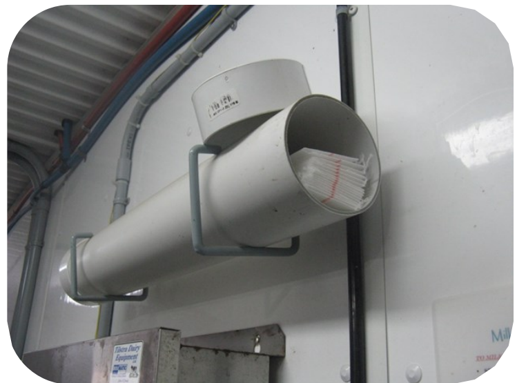
Figure 6: Un autre exemple d'un conteneur de stockage filtre antipoussière, imperméable à l'eau.
