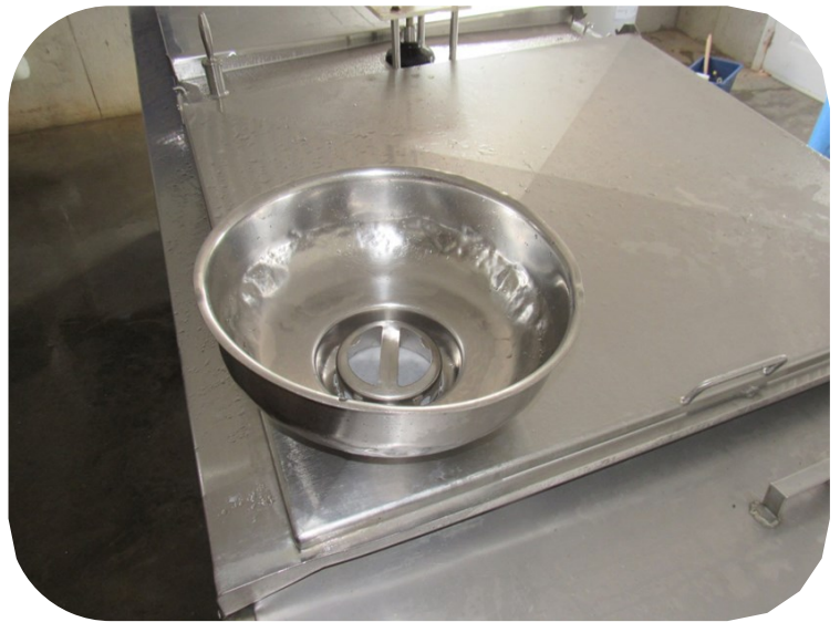
Figure 4: Crépine avec filtre à disque correctement fixé.
