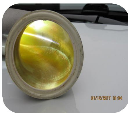
Figure 2: Accumulation de fer sous forme de pellicule jaune-brun.
