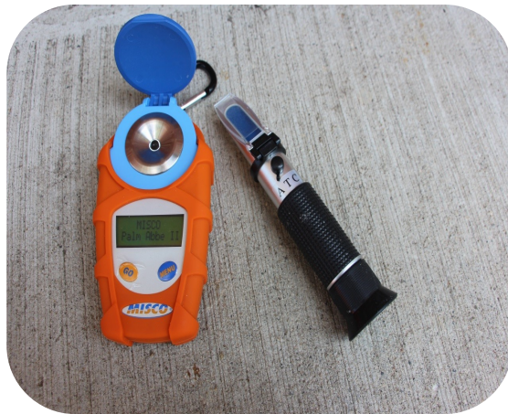
Figure 14. Un exemple de réfractomètre numérique (à gauche) et de réfractomètre optique avec correction de température (à droite).
