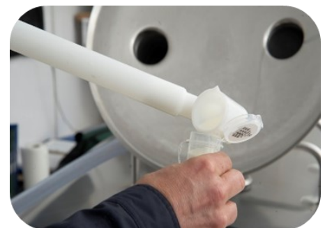
Figure 10 — Une pissette à long manche propre et désinfectée est utilisée pour le prélèvement d'échantillons.
