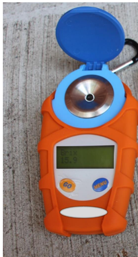
UN RÉFRACTOMÈTRE NUMÉRIQUE RECOUVERT D'UN ÉTUI DE PROTECTION EN CAOUTCHOUC AFFICHANT UNE LECTURE DE 15,9% BRUX.
