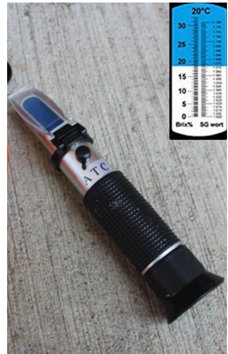
UN RÉFRACTOMÈTRE OPTIQUE ET UN EXEMPLE DE LECTURE OBTENU AU MOYEN DE CE RÉFRACTOMÈTRE.
