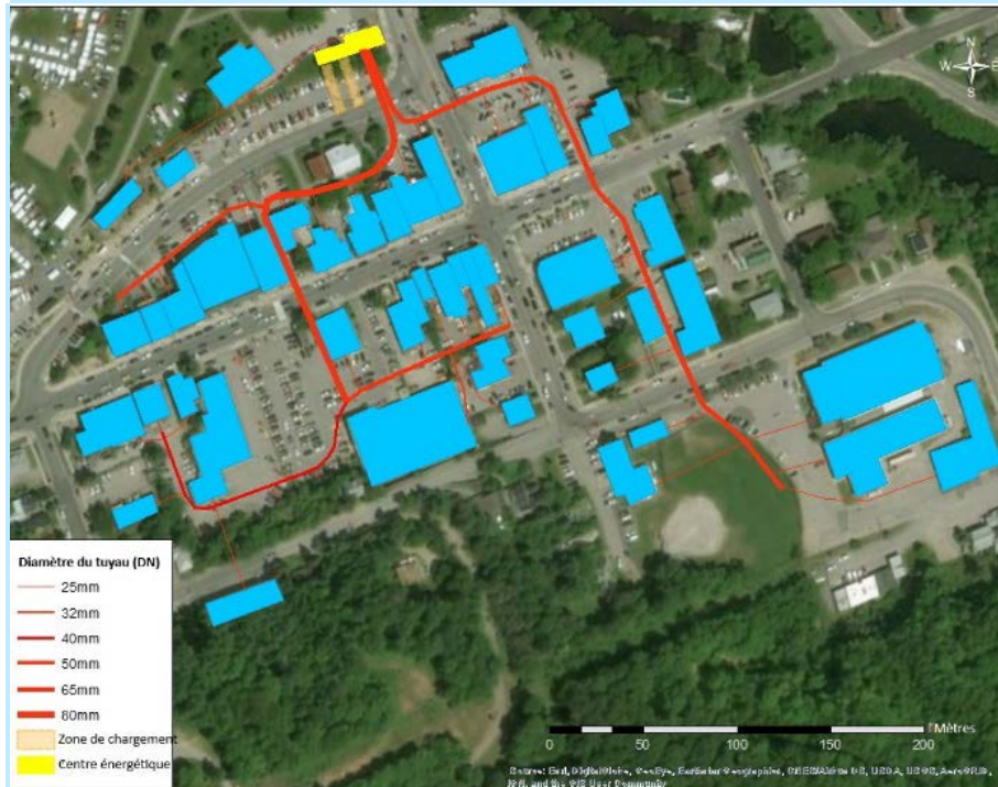
Figure 1.47. Installation de chauffage au bois centralisée proposée par Haliburton Village, vue aérienne
