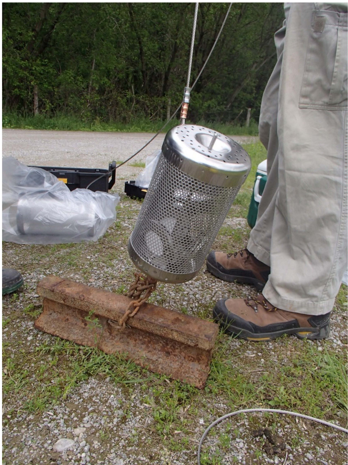
Figure 5 : Échantillonneur intégratif des composés chimiques organiques polaires avant son déploiement dans la rivière East Holland.
