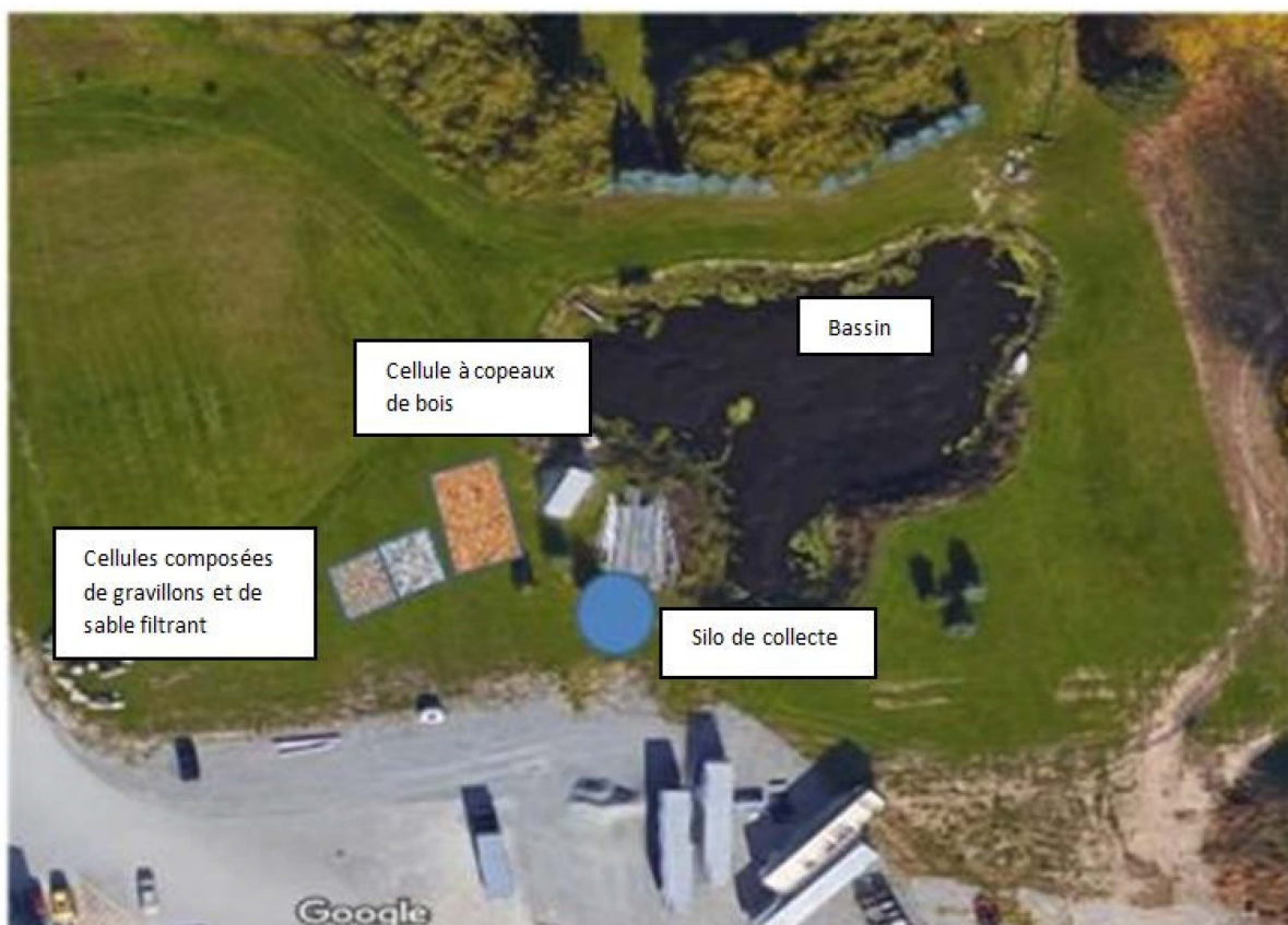
Figure 11 : Schéma d'un système de traitement hybride permanent sur le site d'une serre.
