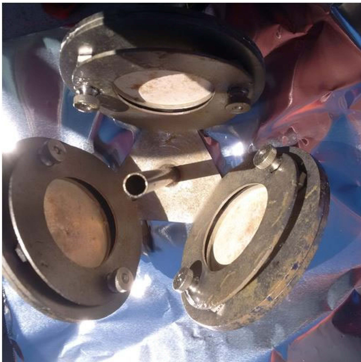
Figure 6 : Échantillonneur intégratif des composés chimiques organiques polaires après son retrait de la rivière East Holland.
