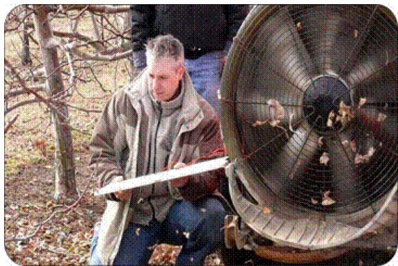
Figure 3 - Les déflecteurs supérieurs et inférieurs concentrent l'air pour le diriger vers le feuillage
