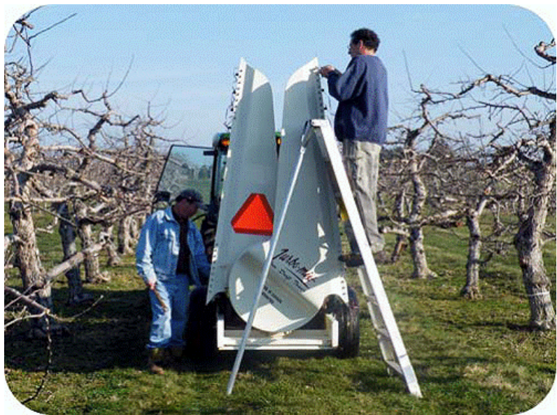
Figure 2 - Séparation d'une tour Turbomist en deux sections pour rediriger l'air
