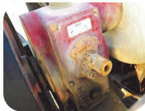
Figure 1. Il faut du temps et beaucoup de travail pour libérer des pièces grippées comme cette boîte de vitesses de ventilateur. Prévoyez une demi-journée de préparatifs par pulvérisateur avant sa remise en service, et assurez-vous de savoir où trouver des pièces de rechange.
