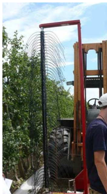
Figure 1. Machine à fils Darwin utilisée pour l'éclaircissage mécanique des fleurs.
